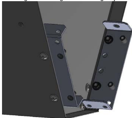
Plaatsing van de beugel binnen het gordijn
