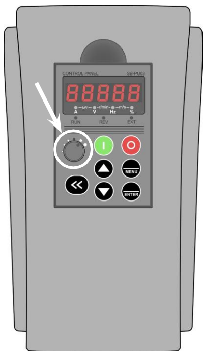
Fig.7.3 Detail van de potentiometer voor het aanpassen van de snelheid motor
